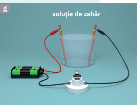
Conductibilitatea electrică a soluției de zahăr
