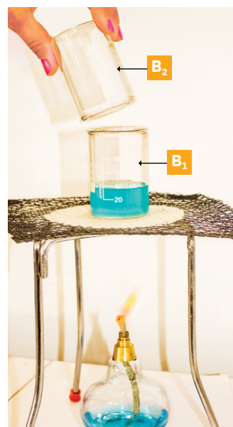
Instalația de încălzire a amestecului de apă și piatră-vânăță
